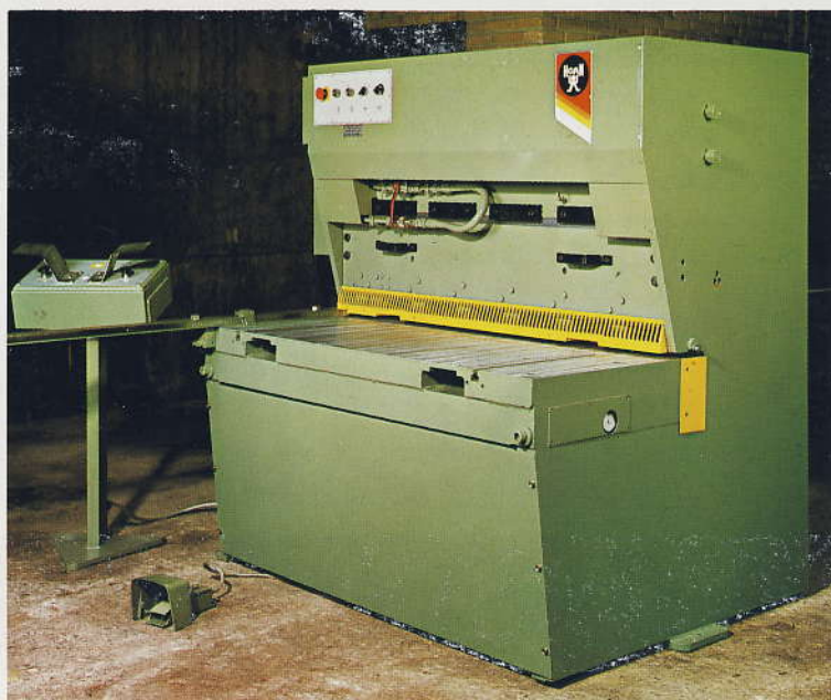
CHE 12/4 special med aftagelig tilholdersystem. Tohåndsmånering. Specialbord.
