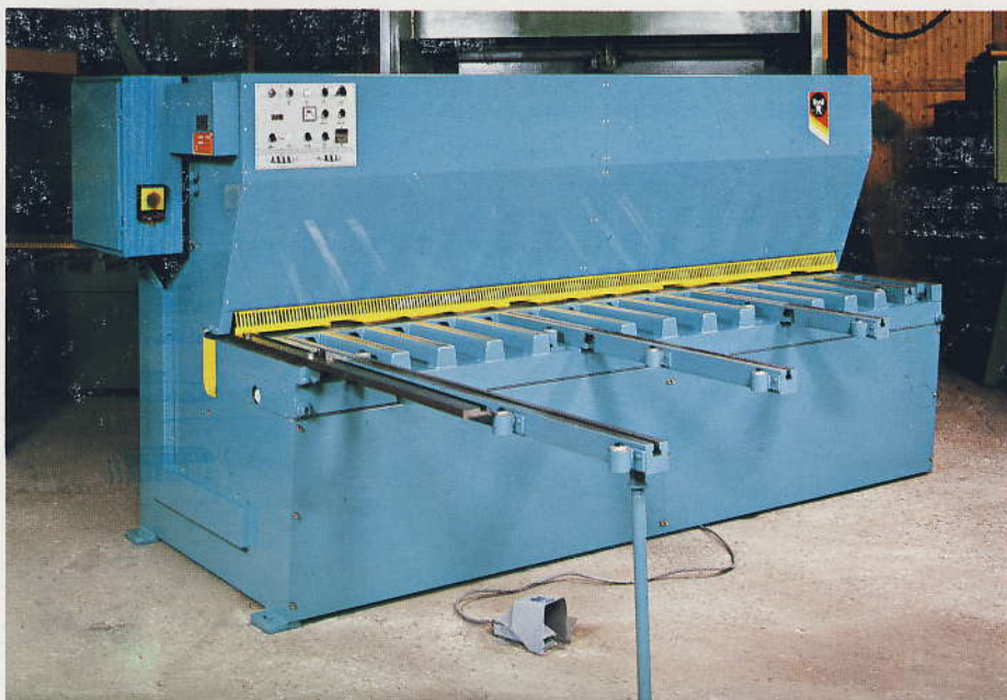
CHE 30/8 QTI Super. Specialbygget pladesaks med lydsvag hydraulik. Lydisolering samt svingningsdæmpende materiale påsat.
