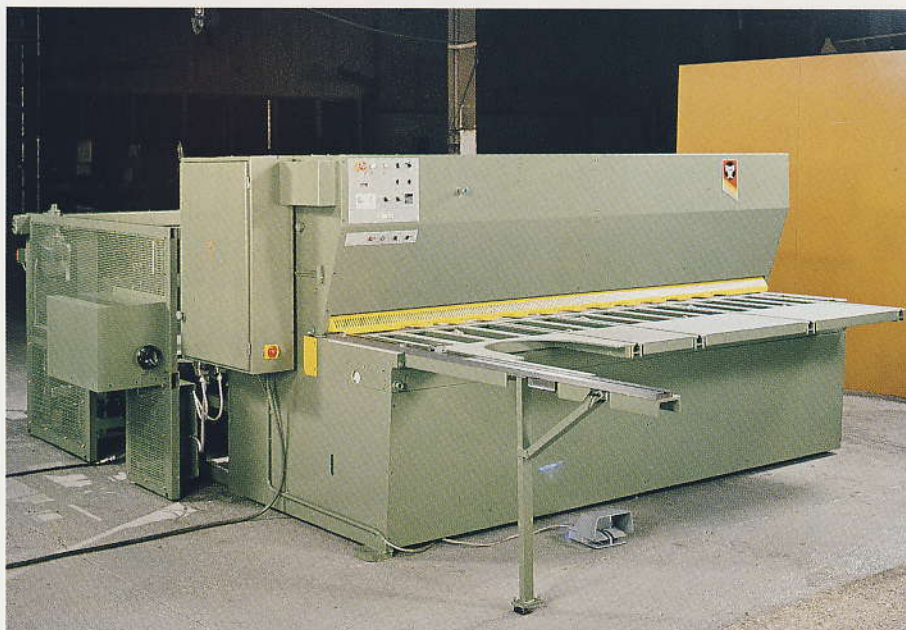
Hydraulisk pladesaks type CHE 30/6 inkl. »delrin-belægning« på bordet. Belægningen forhindrer ridser på aluminium og rustfrit stål.
