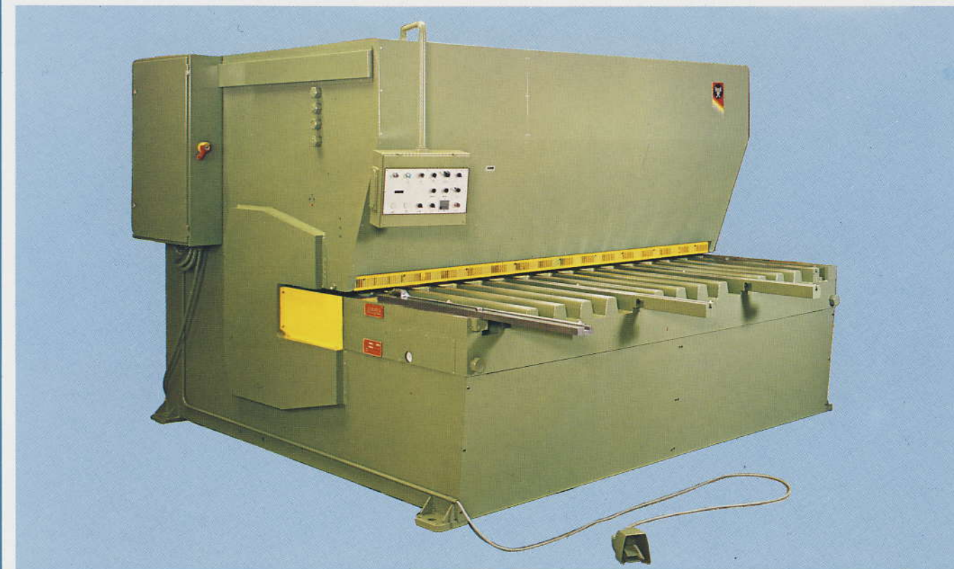
Hydraulisk pladesaks type CHE 30/16 i specialudførelse med 500 mm udladning i sidestativ. ⑦
