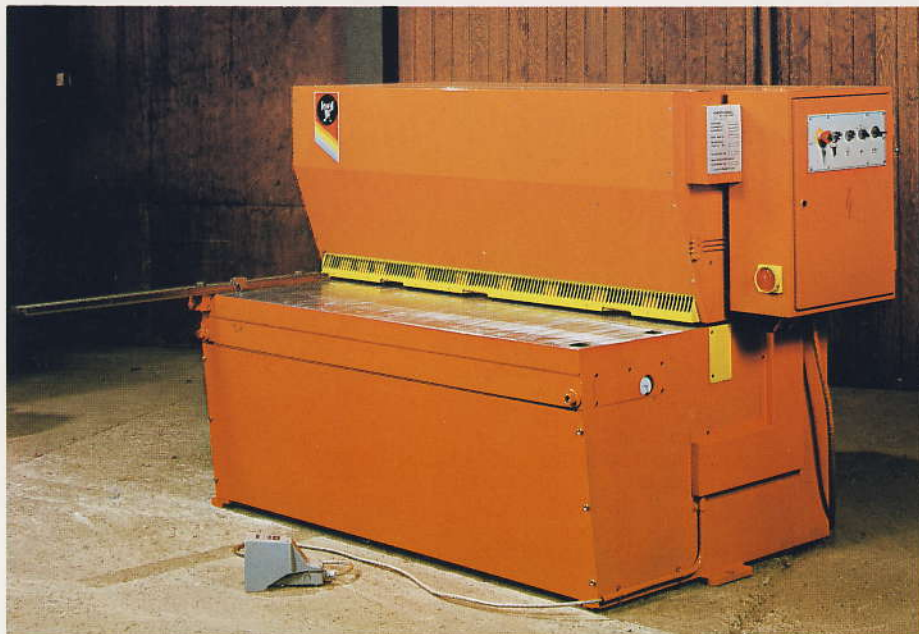
CHE 20/4 i specialudførelse med spejlvendt opbygning af planbord. Manøvrepanel indbygget i el-skab. Maskinen forberedt for indbygning i klippeline.
