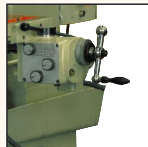
Caja de avances motorizada para la mesa de trabajo. Motorised feed box for the working table. Boîte d'avances motorisée pour la table de travail. Motorischer Antrieb für den Tischverstellung.
